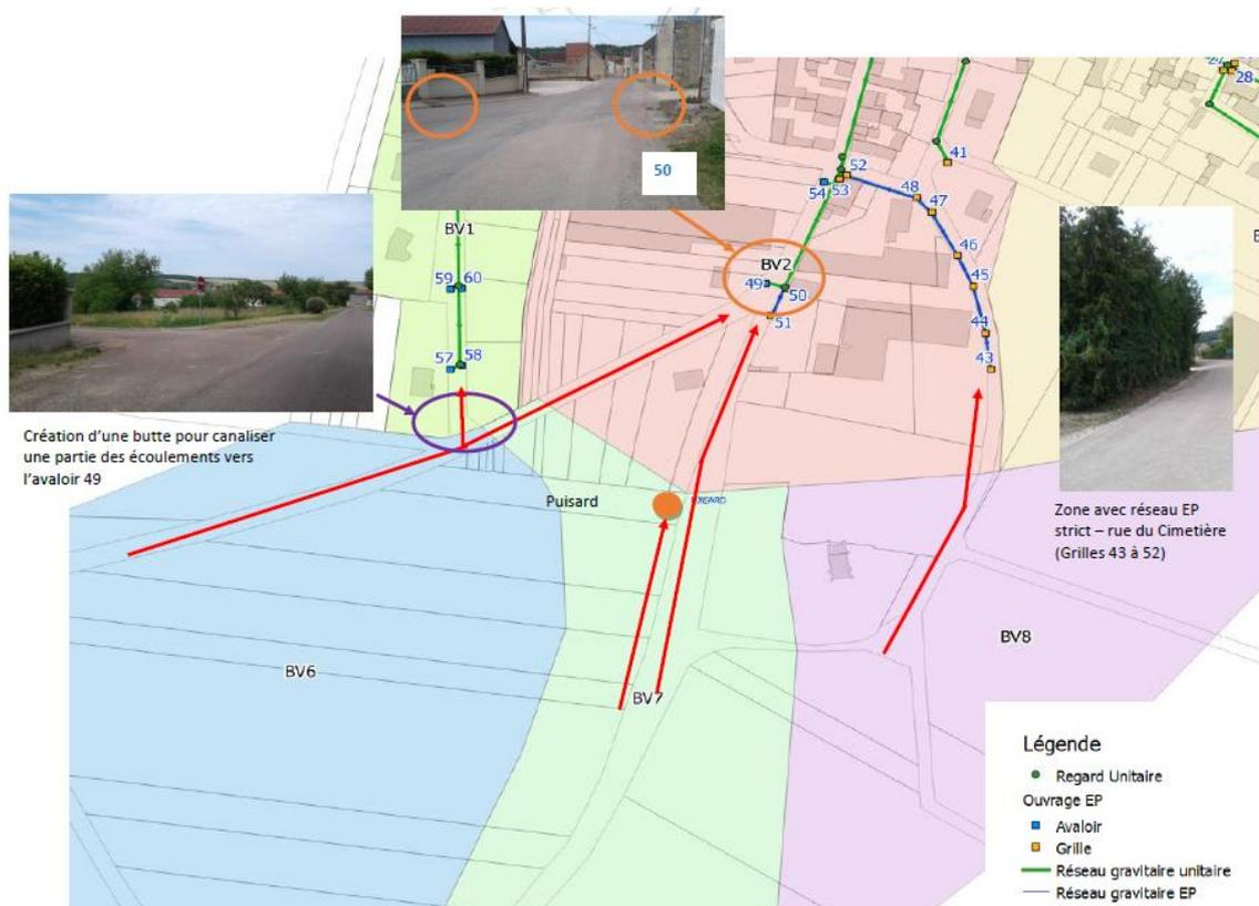
**Figure 17 : Ecoulements principaux au niveau des bassins versants amont**
